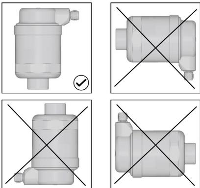
È possibile ruotare la valvola di sfogo aria di 360° e indirizzare così lo scarico dove risulta più opportuno, senza dover arrestare l'impianto.
