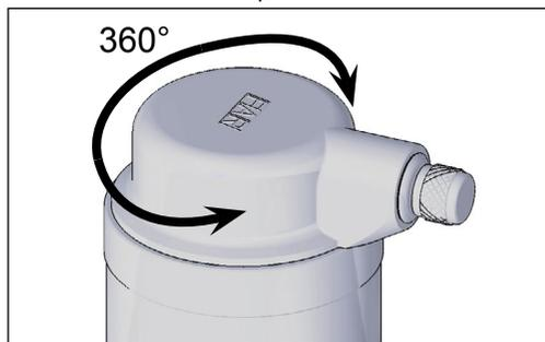
**ATTENZIONE!** Una volta eseguito il riempimento dell'impianto, è consigliato chiudere la valvola di sfogo aria ruotando il tappo in senso orario.
